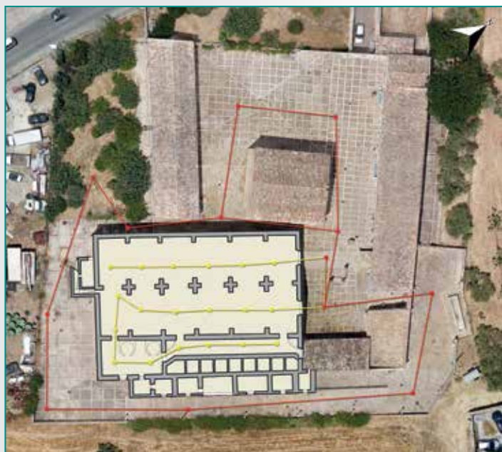
Fig. 4 - Schema della poligonale topografica esterna (in rosso) e della poligonale laser scanner (in giallo).
